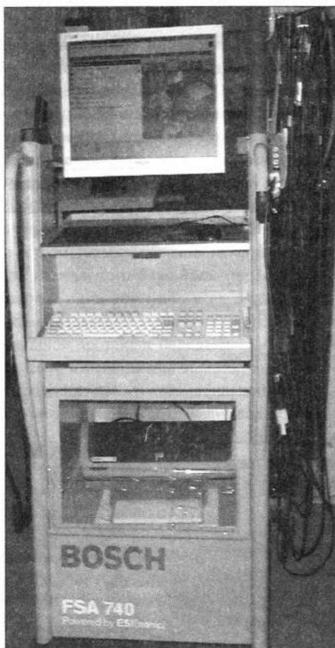
Рис. 9.7. Диагностический прибор FSA 740
