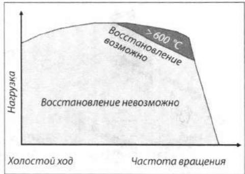
Рис. 8.2. Диапазон восстановления сажевого фильтра без применения дополнительных восстановительных средств
