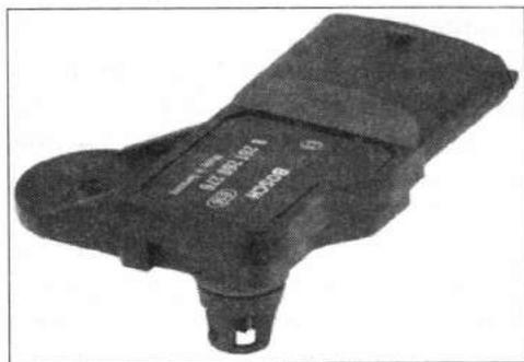
Рис. 11.3. Датчик давления наддува
