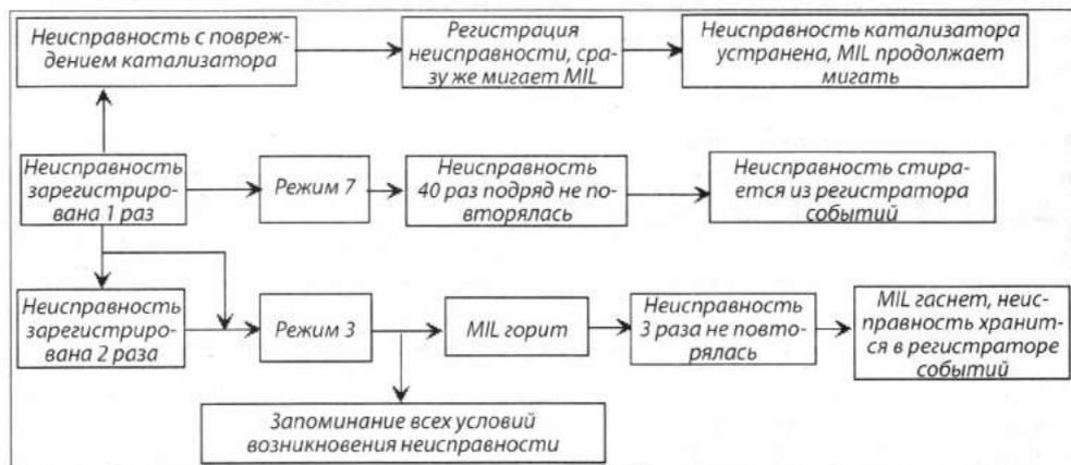
Рис. 9.2. Управление индикатором неисправностей OBD
