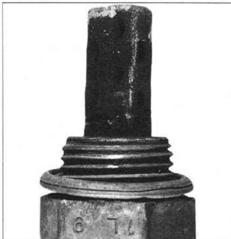
Рис. 7.9. Зонд закопчен
