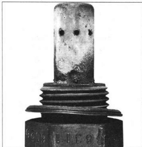
Рис. 7.10. Зонд замазлен
