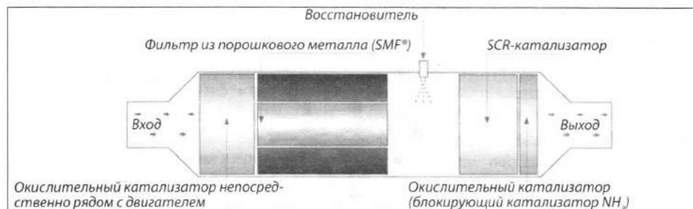
Рис. 8.14. Система CRT с SCR-катализатором [источник: HJS]
