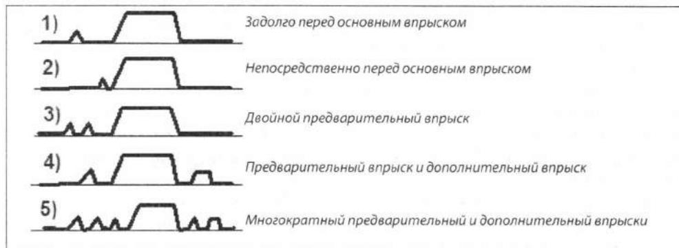
Рис. 5.5. Варианты предварительного впрыска
