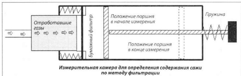
Рис. 2.8. Камера для измерения массы частиц
