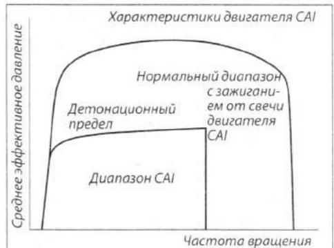
Рис. 5.14. Технология сгорания CAI
