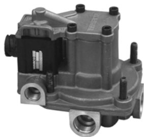
Рис. 33: Разобцающий клапан с тремя пневматическими подключениями
