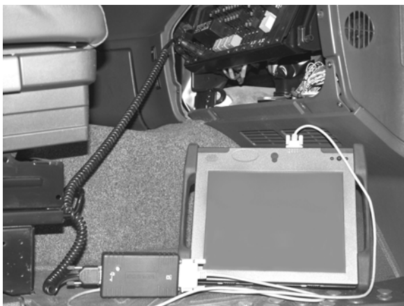
Рис. 39: Подключение диагностического ПК к транспортному средству.
