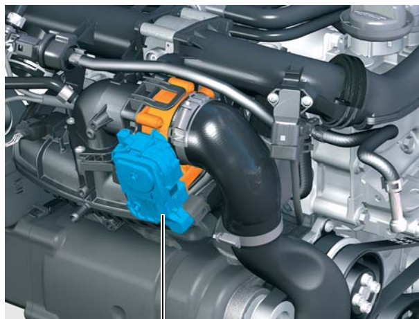
Блок управления дроссельной заслонкой J338 с приводом дроссельной заслонки G186 S359_108
