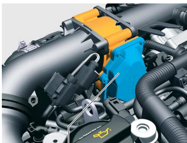
Блок управления регулировочной заслонкой J808 с сервоприводом V380 S359_107
