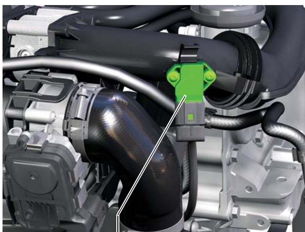
Датчик давления во впускном патрубке G583 с датчиком температуры всасываемого воздуха G520 S359_049
