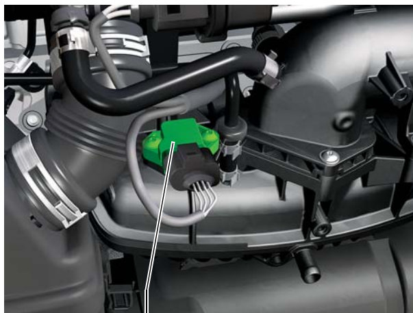
Датчик давления во впускном коллекторе G71 с датчиком температуры всасываемого воздуха G42 S359_047
