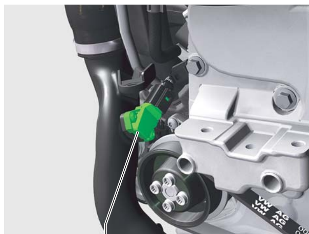
Датчик давления наддува G31 с датчиком температуры всасываемого воздуха G299 S359_062
