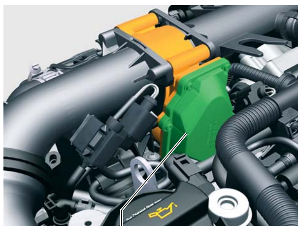
Блок управления регулирующей заслонки J808 с потенциометром регулирующей заслонки G584 S359_052
