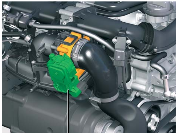
Блок управления регулирующей заслонки J338 с датчиком угла поворота привода дроссельной заслонки G187 и G188 S359_050
