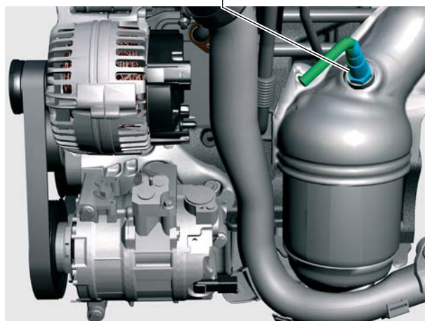
Лямбда-зонд G39 с нагревательным элементом Z19
