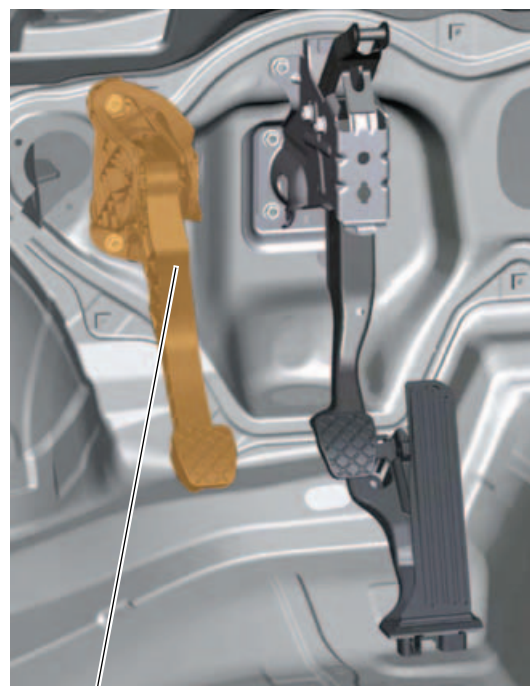
Педаля сцепления с датчиком ее положения
