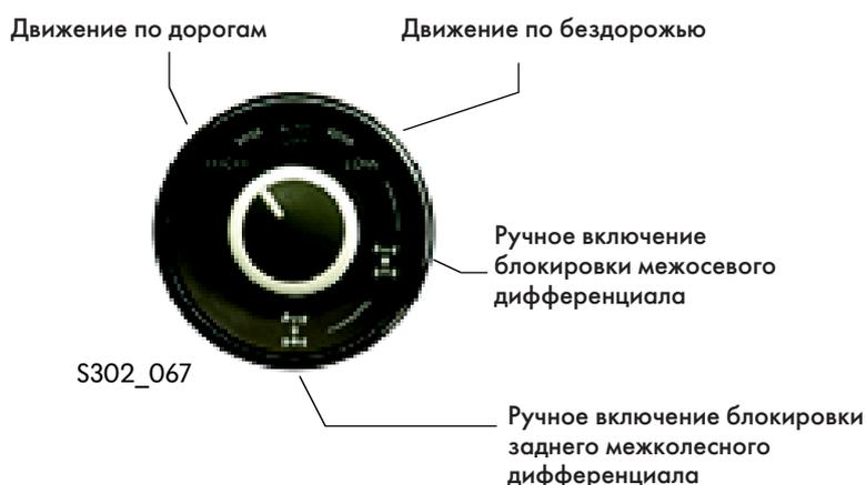
Положение **"HIGH"** поворотного переключателя предназначено для движения по дорогам с нормальным покрытием. Блокировка дифференциалов осуществляется автоматически в зависимости от дорожных условий (например, на льду). При этом не обязательно, как при блокировке дифференциала кулачковой муфтой, полностью блокировать дифференциалы, вполне возможна частичная блокировка. Понижающая передача раздаточной коробки не включена.
