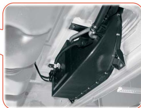
теплообменник грузового отсека/
