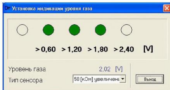
Рис. 3 Установка порогов светодиодов
