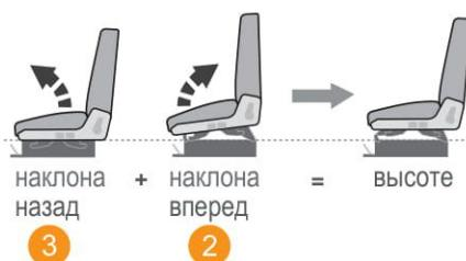
Поднять рычаг (2) и выставить положение наклона сидения, нажимая или поднимая переднюю часть подушки сидения.
