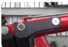
Трехточечное крепление гидроцилиндров телескопа уменьшает их колебания и благоприятно сказывается на управляемости автомобиля.
