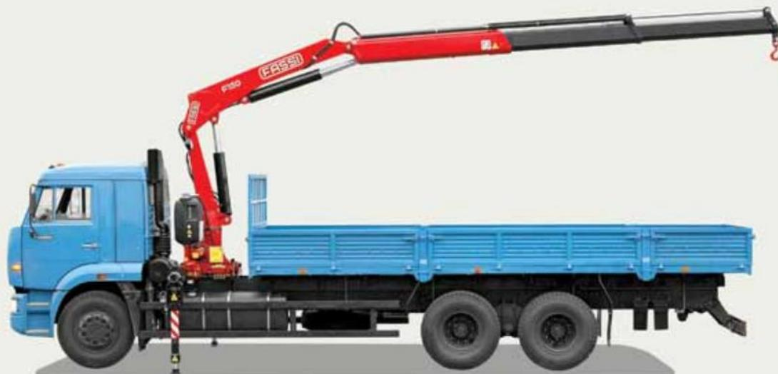
Автомобиль оснащён крано-манипуляторной установкой Fassi, предназначенной для самопогрузки и разгрузки бортовой платформы, а также для выполнения монтажных работ на рассредоточенных объектах. Возможна установка других моделей кранов-манипуляторов Fassi на данное шасси (от серии «Микро» до F 190) за кабиной или на задний свес автомобиля.
