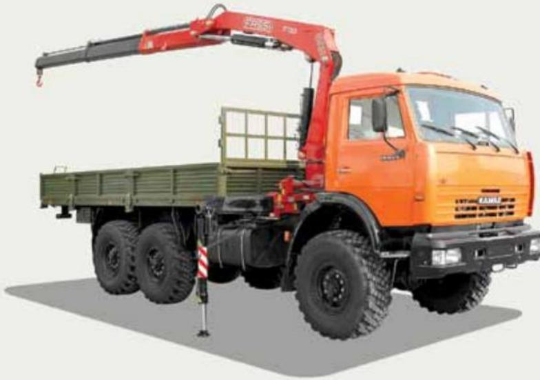
Автомобиль оснащён крано-манипуляторной установкой Fassi, предназначенной для самопогрузки и разгрузки бортовой платформы автомобиля, а также выполнения монтажных работ на рассредоточенных объектах. Возможна установка других моделей кранов-манипуляторов Fassi на данное шасси (от серии «Микро» до F150) за кабиной или на задний свес автомобиля.
