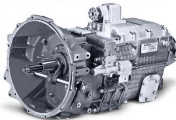
На автомобилях-тягачах, предназначенных для работы в составе автопоездов используется модернизированная десятиступенчатая коробка передач модели 152, состоящая из основной пятиступенчатой коробки передач и переднего двухступенчатого редуктора-делителя.
