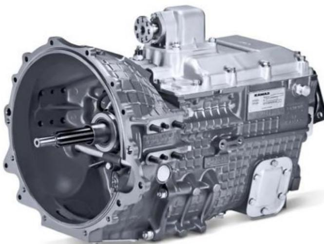
Это модернизированная КП модели 141. При модернизации усилены зубчатые муфты синхронизатора 4-5 передачи, первичного вала КП и шестерни 5 передачи за счет увеличения высоты зуба, изменены замки от самовыключения синхронизатора 4-5 передачи, исключено замковое устройство в шлицевом соединении каретка синхронизатора 4-5 передачи и вторичный вал, что позволило на 15-20% повысить долговечность коробки передач. Применяется КП 141 для автомобилей
