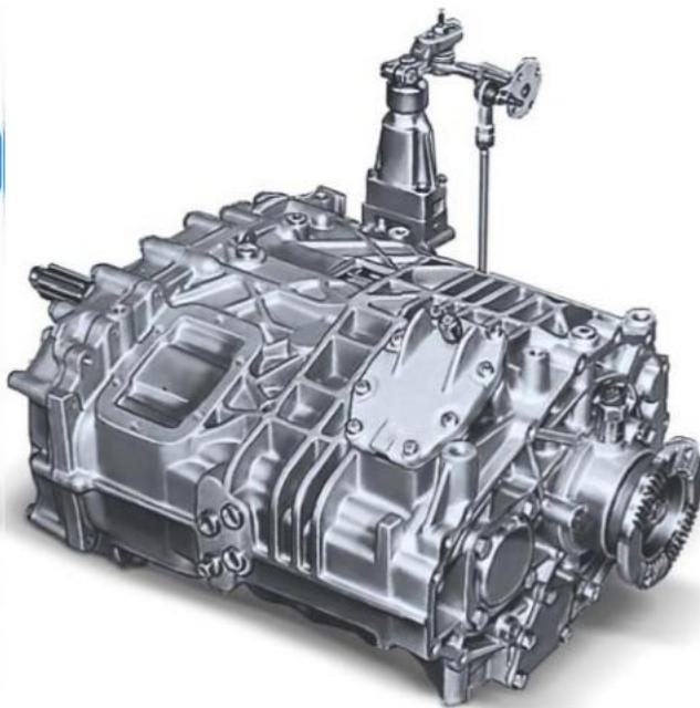
Шестиступенчатая коробка передач модели ZF 6 S 1200 TO устанавливается на шасси КАМАЗ для городских и междугородных автобусов. Коробка передач представляет собой шестиступенчатый редуктор. Все передачи переднего хода в основном редукторе включаются
