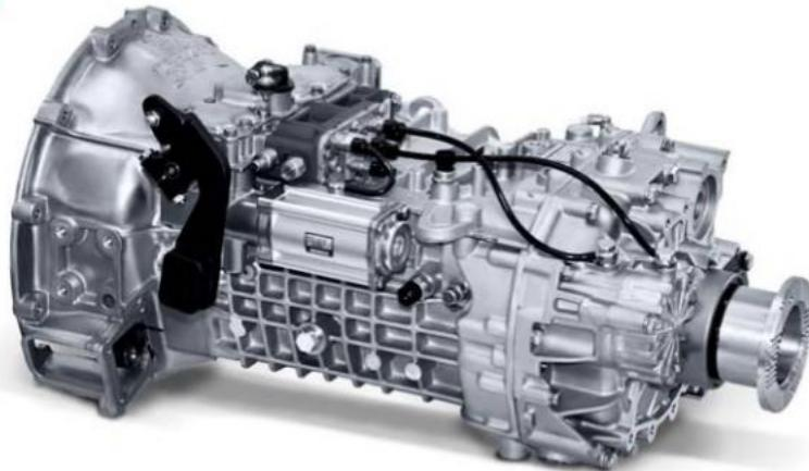
Девятиступенчатая коробка передач модели ZF 9 S 109 / 9 S 1310 ТО устанавливается на шасси, самосвальы, транспортные автомобили КАМАЗ средней грузоподъемности. Коробка передач состоит из следующих основных узлов: основного пятиступенчатого редуктора и демультиплликатора. Поникающая «ползучая» передача основного редуктора используется только в нижнем диапазоне работы демультиплликатора. Четыре передачи переднего хода в основном редукторе
