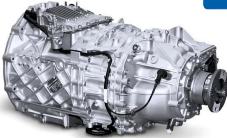
Двенадцатиступенчатая автоматизированная коробка передач модели ZF 12 AS 1930 TD устанавливается на шасси, магистральные автомобили КамАЗ тяжелого семейства. Коробка передач состоит из следующих основных узлов: основного трехступенчатого редуктора с двумя промежуточными валами, переднего двухступенчатого делителя передач и демультиплликатора. Все передачи переднего хода в основном редукторе включаются зубчатыми муфтами. Выравнивание угловых скоростей промежуточного вала и шестерен вторично-
