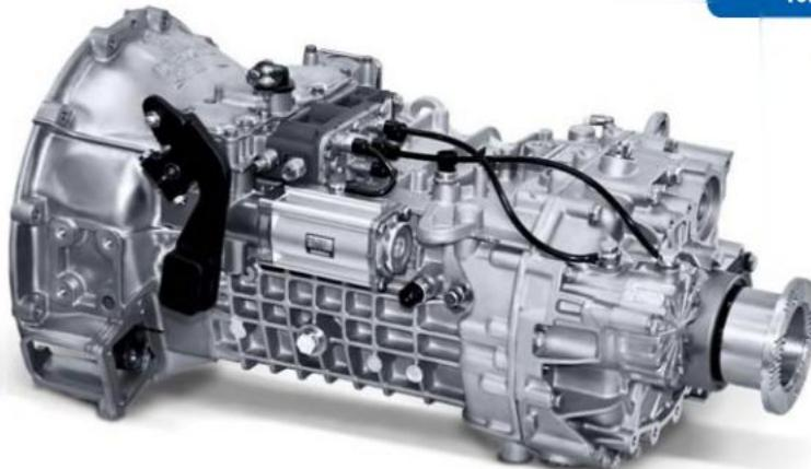
Девяноступенчатая коробка передач модели ZF 9 S 1315 TO устанавливается на шасси, транспортные автомобили КАМАЗ средней грузоподъемности. Коробка передач оборудована резервным насосом рулевого управления с приводом от ведущих колес, обеспечи-
