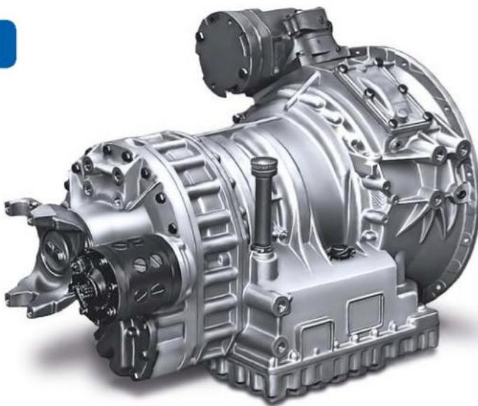
Автоматическая гидромеханическая коробка передач модели ZF 6 HP 602 устанавливается на шасси, полноприводные автомобили КамАЗ тяжелого семейства. Коробка передач состоит из следующих основных узлов: гидротрансформатора, шестиступенчатой планетарной коробки передач с автоматическим управлением. Имеется возможность установки до двух коробок отбора мощности с отбором мощности от двигателя. Масса коробки передач составляет 300 кг. Максимальный крутящий момент 1600 Нм.
