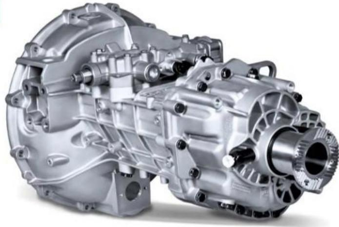
Шестиступенчатая коробка передач модели ZF 6 S 700 TO устанавливается на шасси, легкие развозные автомобили КАМАЗ. Коробка передач представляет собой шестиступенчатый редуктор. Все передачи пе-
