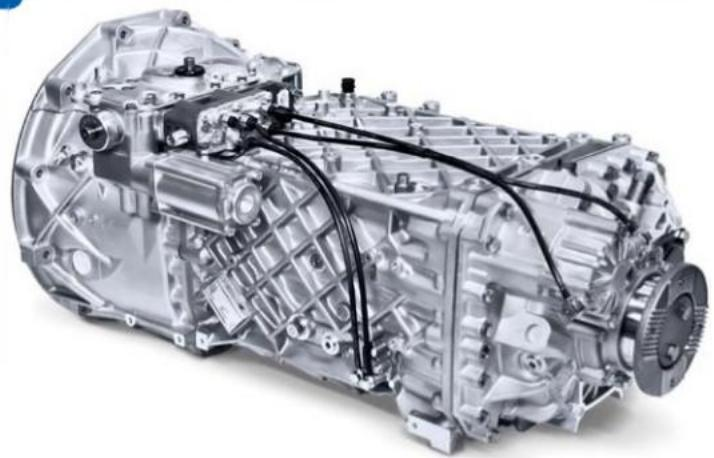
Шестнадцатиступенчатая коробка передач модели ZF 16 S 151 / 16 S 1820 TO устанавливается на шасси, самосвалы, магистральные автомобили КАМАЗ тяжелого семейства. Коробка передач состоит из следующих основных узлов: основного четырехступенчатого редуктора, переднего двухступенчатого делителя передач и демультиплликатора. Все передачи переднего хода в основном редукторе включаются синхронизаторами, задняя передача — зубчатой муфтой. Высшая
