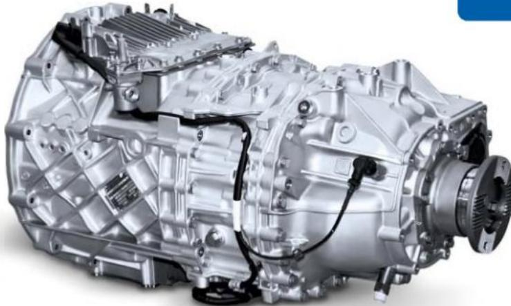
Двенадцатиступенчатая автоматизированная коробка передач модели ZF 12 AS 1930 ТО устанавливается на шасси, магистральные автомобили КамАЗ тяжелого семейства. Коробка передач состоит из следующих основных узлов: основного трехступенчатого редуктора с двумя промежуточными валами, переднего двухступенчатого делителя передач и демультипликатора. Все передачи переднего хода в основном редукторе включаются зубчатыми муфтами. Выравнивание угловых
