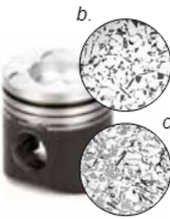
b. Микроструктура алюминиевого сплава (АК-18)
