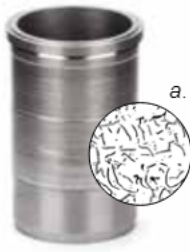
a. Микроструктура серого чугуна
