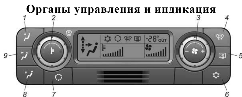
Рис. 8.1. Пульт управления отопительно-вентиляционной и климатической установкой
